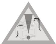
**SOLO DOPO TERMINATA L'INSTALLAZIONE ELETTRICA COLLEGARE IL MORSETTO NEGATIVO DELLA BATTERIA**, abbinare la sirena wireless (**vedi pag.11 del manuale installatore**) ed eseguire tutti i test funzionali del sistema prima di consegnare la vettura.
